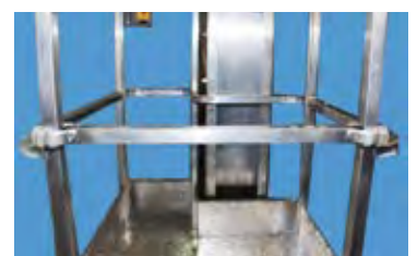
Entrada a plataforma con barra de seguridad móvil
